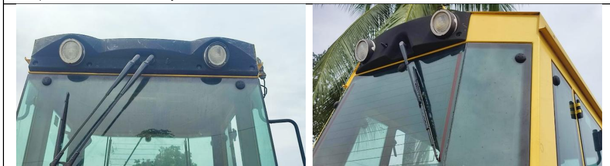
Remplazar faros de trabajo de 12 voltios
