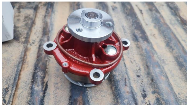
Bomba de agua
