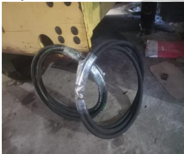
Manguera de motor vibrador hacia la bomba hidráulico
